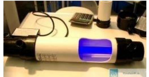
Una parte dell'acqua del circuito dell'acquario viene fatta passare attraverso uno speciale tubo fluorescente con spettro UV in un tubo più spesso. Il tubo stesso è installato in una zona asciutta a tenuta stagna al centro del chiarificatore UV.
