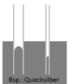
Effetto capillare inverso: se si mette un oggetto in un liquido, avviene esattamente l'effetto opposto. La superficie del liquido si curva verso l'alto intorno all'oggetto. Questo è esattamente ciò che si osserva, per esempio, quando si inserisce un idrometro.
