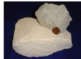
**Le zeoliti** sono minerali silicatici inerti con una struttura altamente porosa, simile a una spugna, e una **superficie** corrispondentemente **grande**. Formano quindi delle aree di insediamento ottimali per i microrganismi, come i batteri, sulla superficie e anche all'interno.
